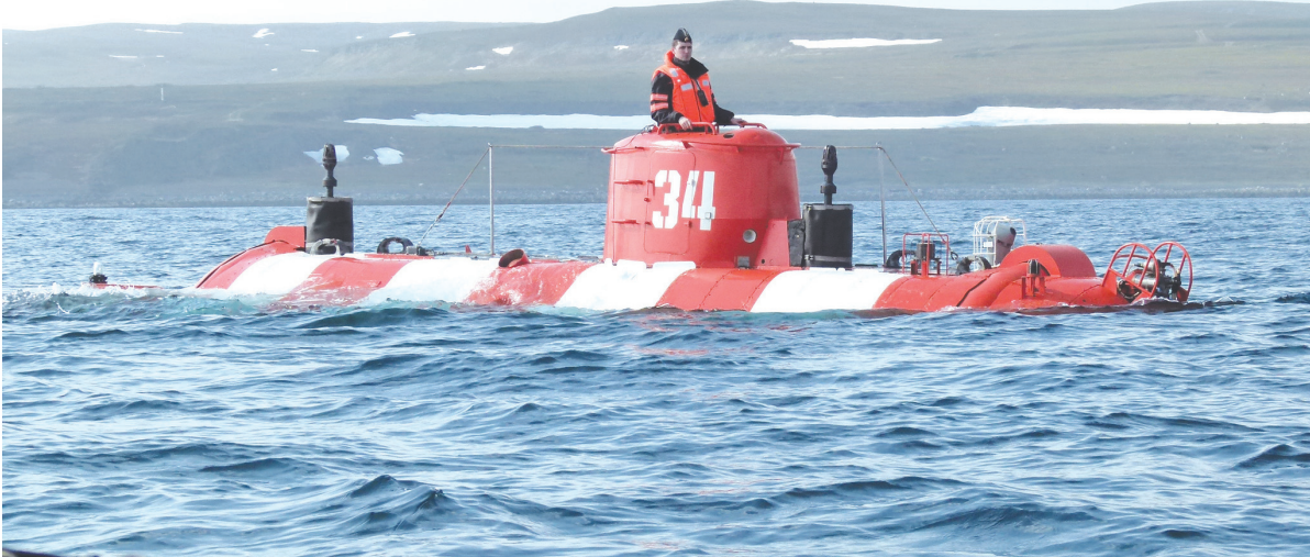
Глубоководный спасательный аппарат АС-34 готовится к погружению.
